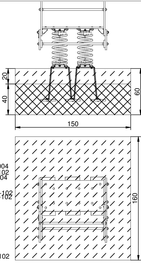
Detalles de la cimentación necesaria en condiciones normales (debería tenerse cuidado en lo referente a las condiciones anormales).
