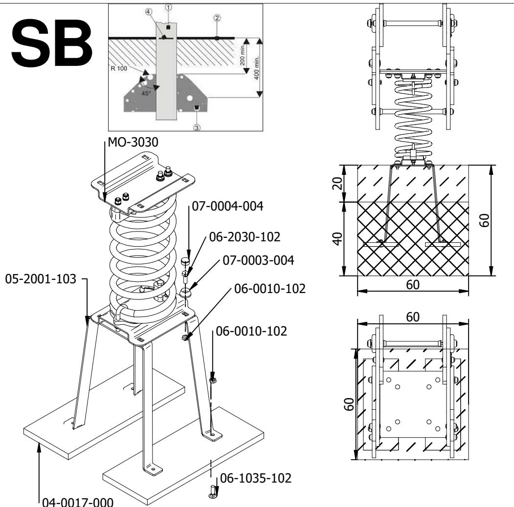
Detalles de la cimentación necesaria en condiciones normales (debería tenerse cuidado en lo referente a las condiciones anormales).
